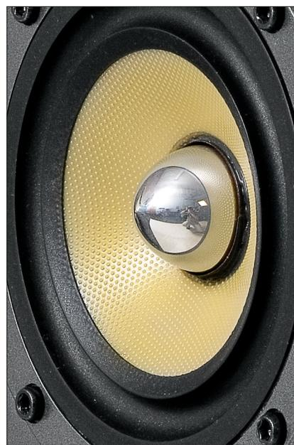
◀ Несмотря на то, что конструкция СЧ/НЧ- и НЧ-динамиков различается, во всех драйверах применяется одинаковый инвертированный подвес диффузоров
